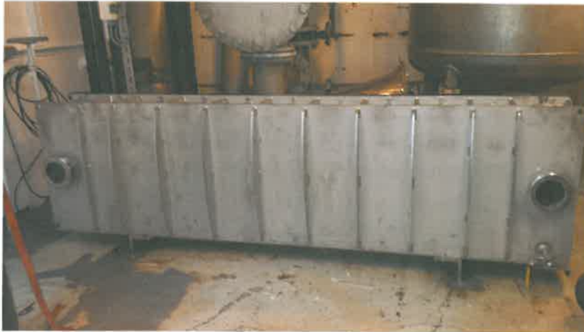
Bilde 1. Fordamper montert i båt.
